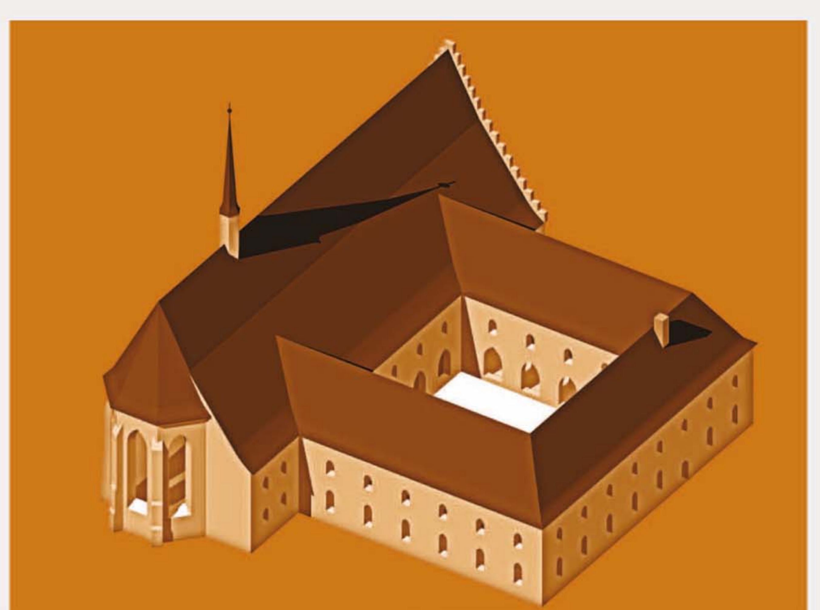
Rekonstruktionsversuch der mittelalterlichen Klausuranlage des Luckauer Dominikanerklosters. Der Ost- und der Westflügel besaßen annähernd die gleiche Breite. An den einschiffigen Chor schloss sich ein asymmetrisches zweischiffiges Langhaus an.
