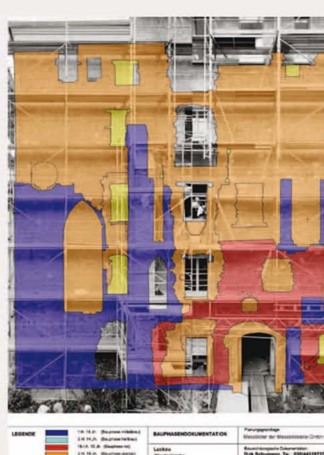
Bauphasenkartierung der Westfassade. Während der Sanierung der Westfassade, während der Sanierung festgestellt werden, die teilweise mit glasierten Formsteinen ausgeführt wurde. Rekonstruktionsversuch der mittelalterlichen Gliederung der Westfassade sowie Formsteinprofil des Gewändes des großen Westfensters. Darstellungen: Dirk Schumann
